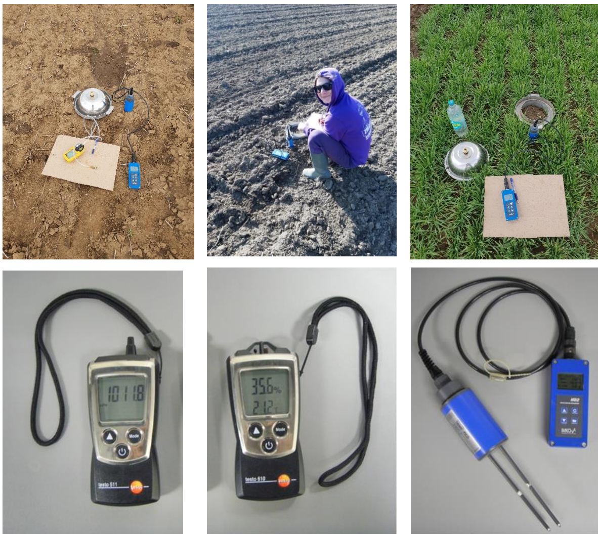
Slika 2.9.9. Mjerenje koncentracije ugljikovog dioksida iz tla i agroekoloških čimbenika
