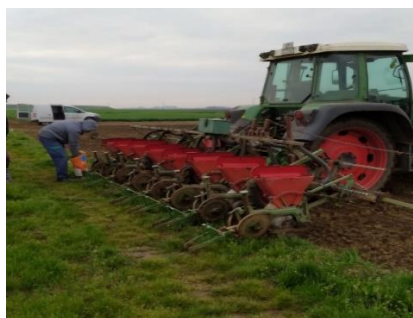
Slika 2.1.10. Sijačica za kukuruz
