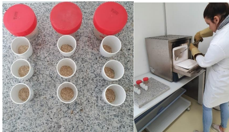
Slika 2.4.6. Uzorci prije analize koksa (lijevo), analiza koksa (desno)
