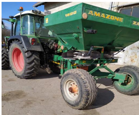
Slika 2.1.4. Rasipač mineralnog gnojiva
