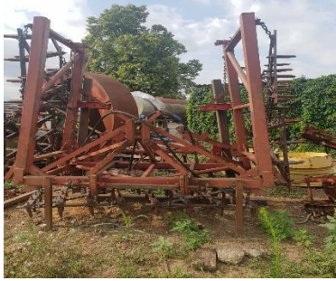
Slika 2.1.12. Plošna klinasta drljača
