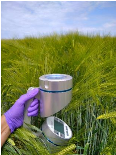
Slika 2. Uređaj za sakupljanje zraka „Air sampler“
