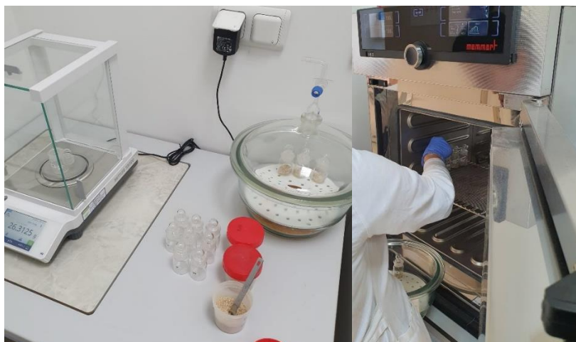
Slika 2.4.4. Priprema uzoraka za analizu vlage/suhe tvari (lijevo); Laboratorijska sušnica Model 30-1060, Memmert, Njemačka (desno)
