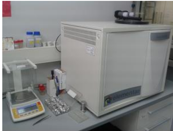
Vario, Macro CHNS analizator
