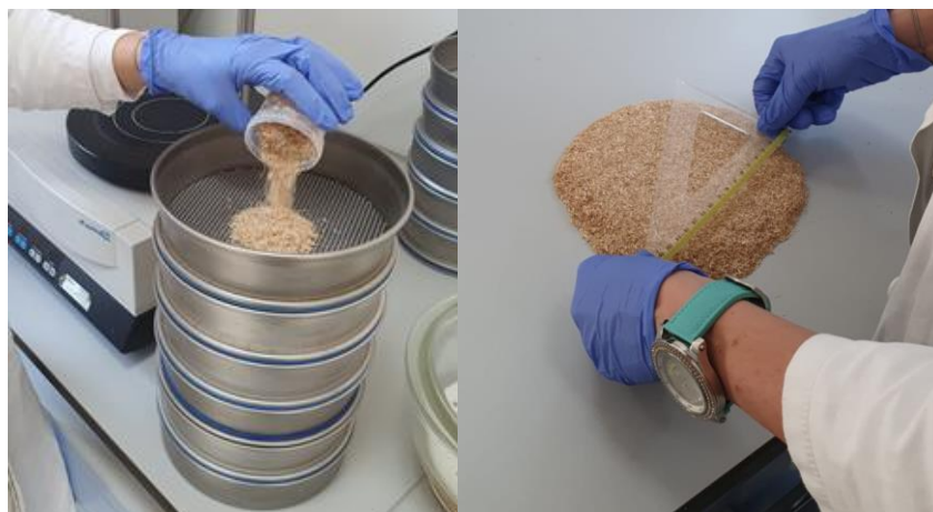
Slika 2.4.3. Sito tresilica - lijevo (AS 200, Retsch GmbH, Njemačka); uzorkovanje metodom četvrtanja - desno
