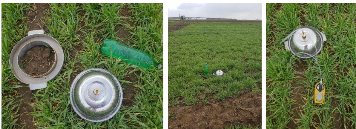
Slika 2.9.8. Mjerenje koncentracije ugljikovog dioksida iz tla
