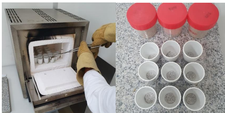
Slika 2.4.5. Određivanje sadržaja pepela; uzorci prije analize u mufolnoj peći (lijevo), uzorci nakon analize (desno)
