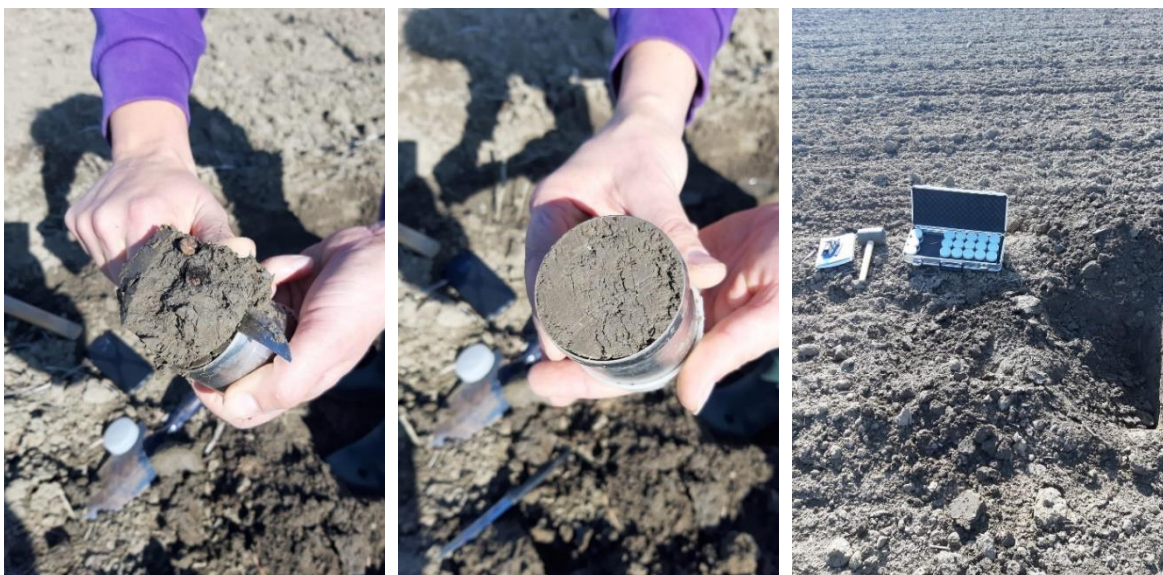
Slika 2.9.2. Uzorkovanje tla u neporušenom stanju Kopeckevim cilindrima
