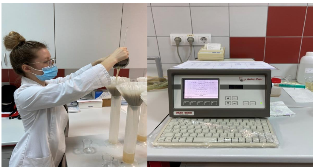
Slika 2.3.8. Filtriranje i određivanje sladovine
