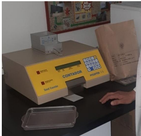
Slika 2.3.5. Određivanje mase 1000 zrna
