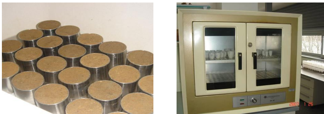
Slika 2.9.3. Priprema uzorka tla za laboratorijske analize
